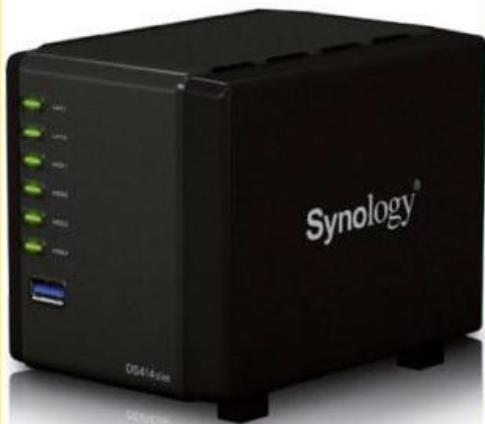
▲ Avec la multiplication des gammes, on peut trouver un NAS à quatre baies aussi gros qu'un à deux baies grâce à l'utilisation de disques en 2,5 pouces.
