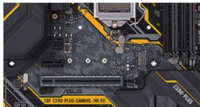
▲ Le slot M2 sur un PCB de carte mère est parfois configurable en SATA ou en PCI-Express. Les différents pas de vis servent à fixer des modules de différentes longueurs.
