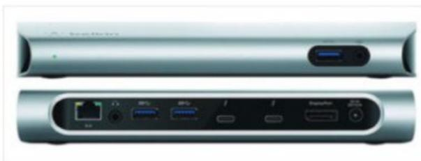
▲ Les choix radicaux d'Apple sur le Thunderbolt 3 nécessitent de recourir à des docks externes pour récupérer la connectique supprimée des portables. Ici ce dock Belkin propose une connectique DP, Thunderbolt, USB 3.1 Gen 2, RJ-45 (réseau) et audio.
