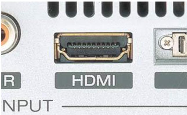
En termes de capacités, l'interface HDMI permet d'obtenir des débits de l'ordre de 5 Gb/S (HDTVC à 2,2 Gb/S - *High-bandwidth Digital Content Protection*). Elle permet ainsi de transmettre :
